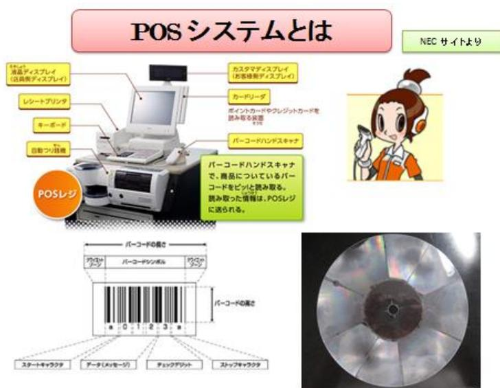
るかが大問題。当時 NEC から、読み取りにレーザー光線を使用するが、バーコードをつけた商品をおこの読取装置のうえを通すときに、どんな角度で商品を流しても読み取りができるようにと、レーザー光の屈折をする必需がありました。そのために開発されたのがこのホログラムレンズです。円盤に、八通りの屈折角が得られるようなレンズを彫り込んであります。こうすれば、1つのレーザー光線が八つに分散し、それに応じて、い
