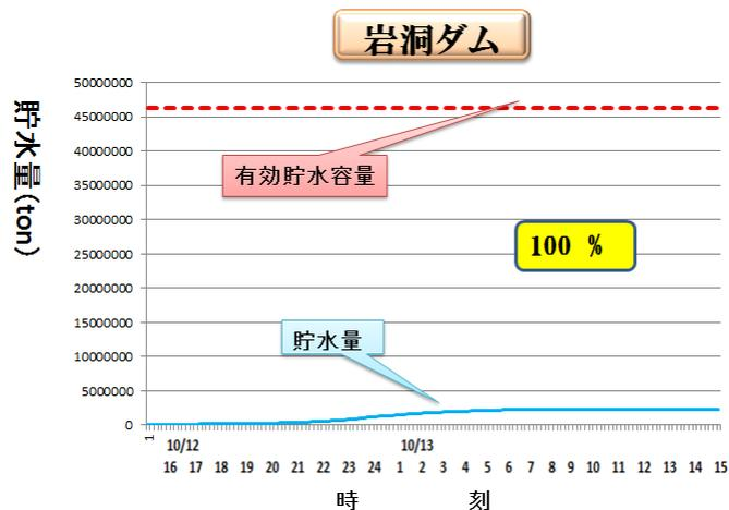
図 2-2 岩洞ダムの貯水の状況
