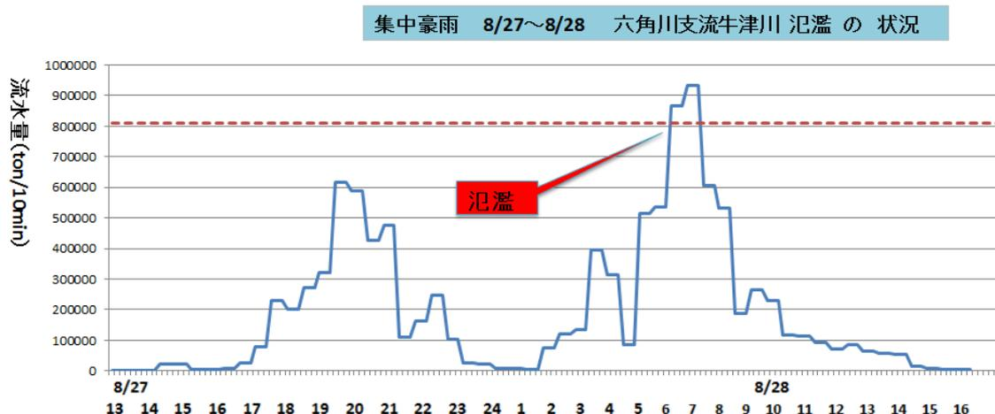
図 2-5 牟田部調整池での貯水がない場合の牛津川の河口付近での状況
