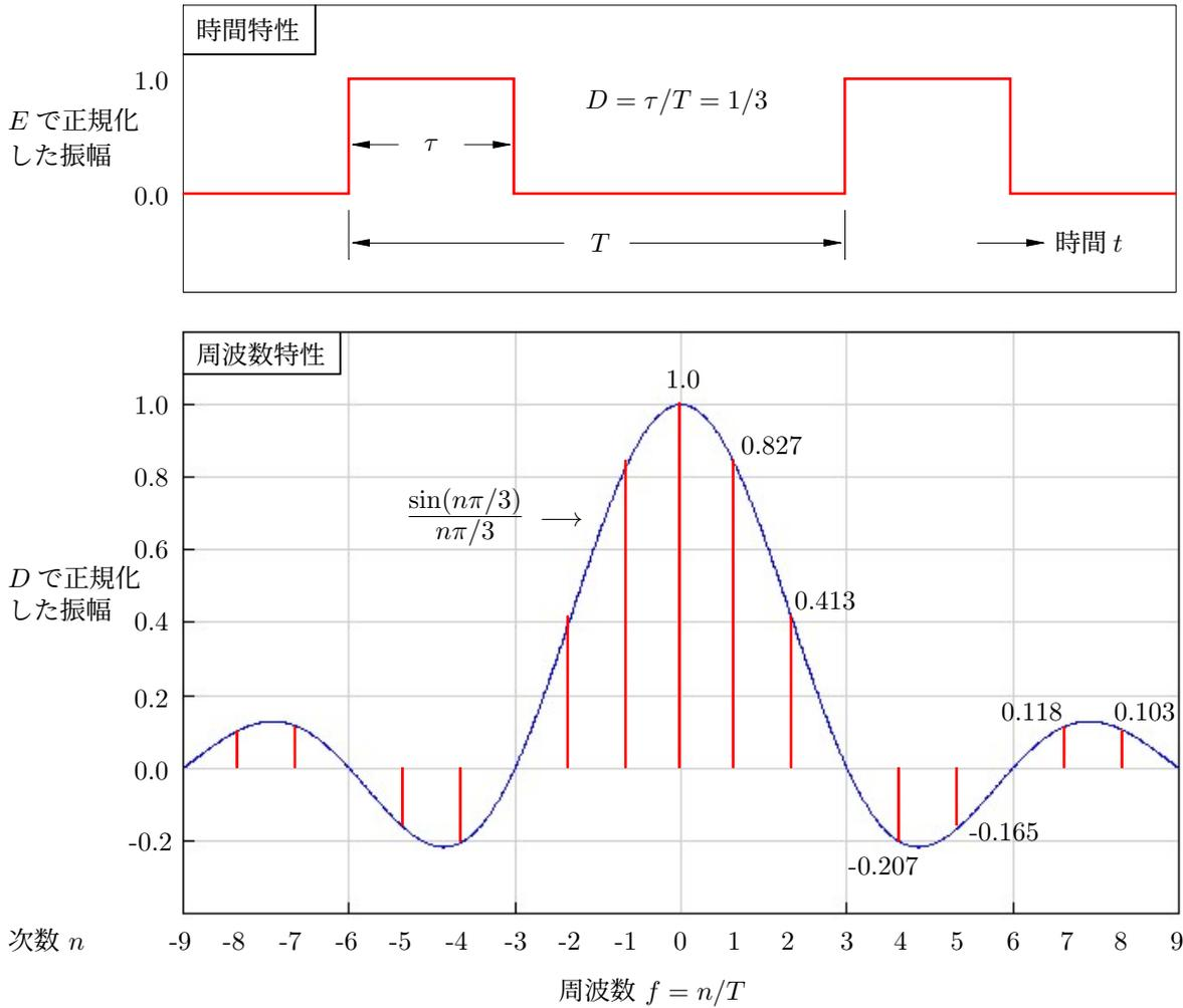
さて、実際の連続パルス信号の離散スペクトルの大きさを知るには最初の式 (1) を計算すれば良いのであるが、 $\tau$ 及び $T$ の値に対応する離散スペクトルの現れ方を概念的に把握することが有用である。それを要約すると、次のとおりである。
