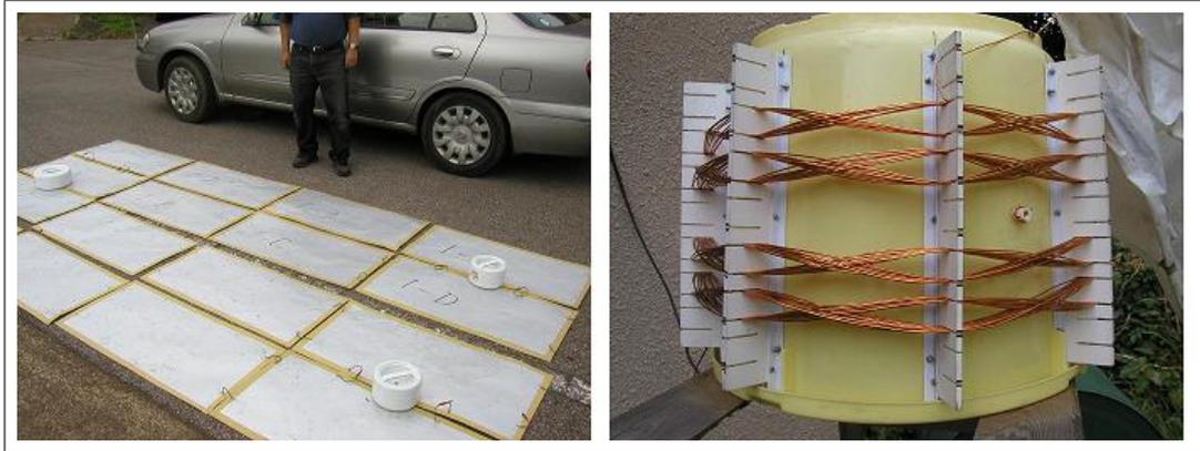
図 8: 損失を減らす工夫 (左:接地効果の良いアースマット 右:スパイダ巻した共振コイル)
