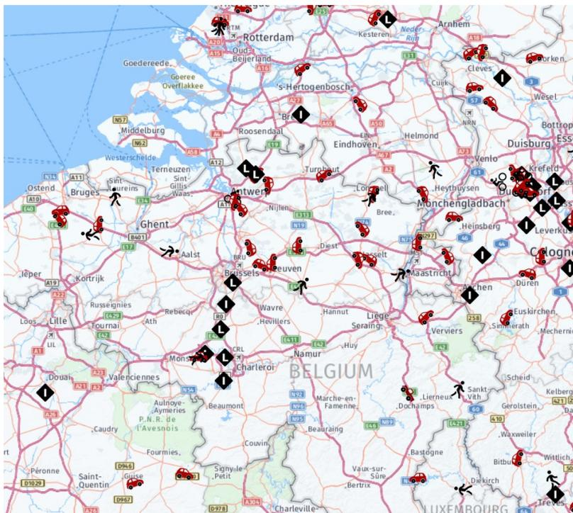
移動局は”Car”または”Person”のシンボルマークで現在位置が表示されていますが、それが標準方式の APRS か LoRa APRS かは区別できません。固定局の”I”は標準方式の iGate であり、”L”が LoRa の iGate です。
