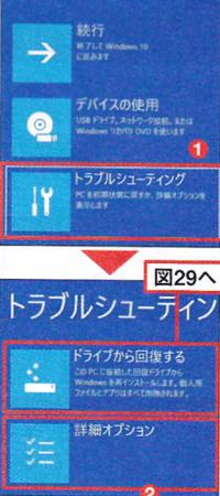
図10 回復ドライブから起動すると「キーボードレイアウトの選択」が開くので「Microsoft IME」を選ぶ。「オプションの選択」では「トラブルシューティング」を選び(1)、「詳細オプション」から「スタートアップの修復」を選ぶ(2,3)
